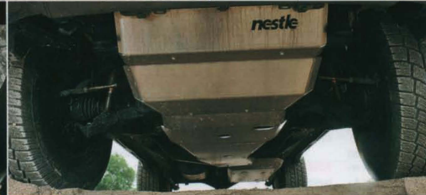
GESCHÜTZT: Alle empfindlichen Partien stehen unter Schutz: Kühler, Motor, Getriebe und Tank.
