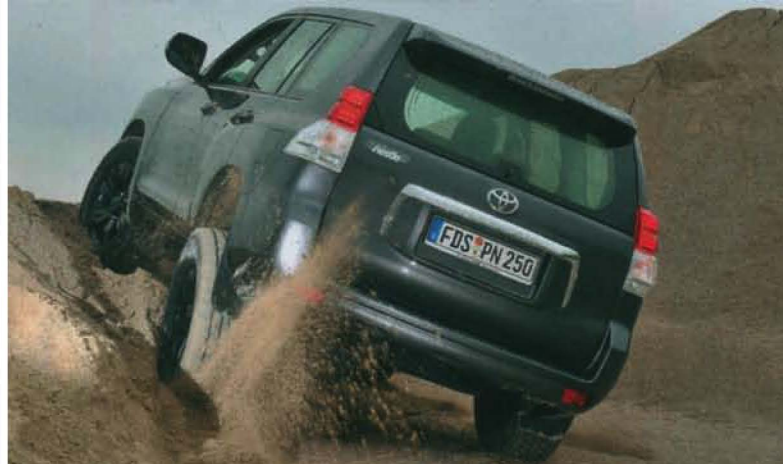
CRUISER-GEN: 205 mm diagonale Achsver-schränkung sind noch übrig.
