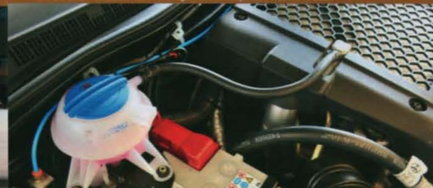
Mehr Wirkung durch höheren Wirkungsgrad bei der Ladeluftkühlung erzielt Nestle mit einem Wasser-Luft-Ladeluftkühler. Für dessen Kühlwasser gibt es einen separaten Wasserkreislauf.
